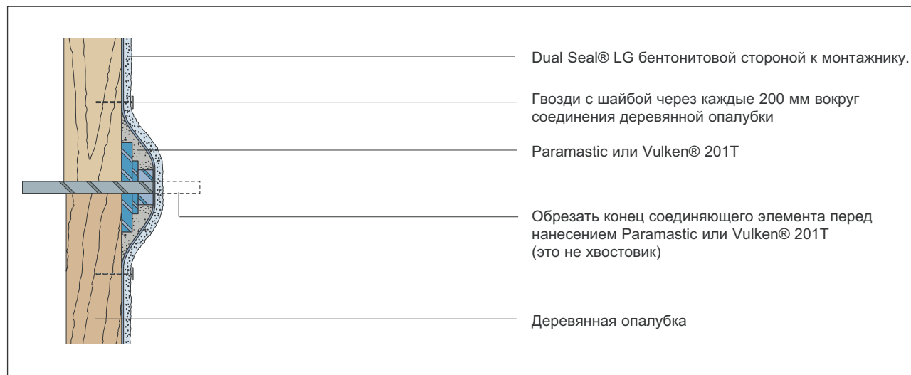
Схема 4. Установка Dual Seal® LG на соединение опалубки.
